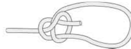
nœud M de chaise F simple bowline as M de guía F Palstek M gassa F d'amante M
